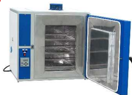
Рис.3. Шкаф сушильный с принудительной циркуляцией
